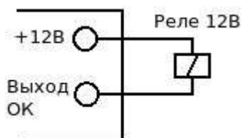
Реле следует выбрать из расчета допустимой нагрузки и удобной конструкции. Обычно такие реле называются “промежуточные реле” и имеют исполнение на DIN рейку.
