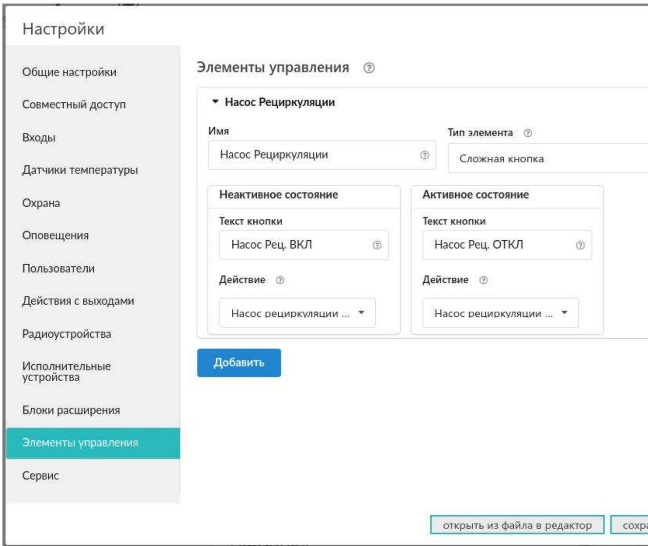
Дополнительно сделаем онлайн индикатор состояния насоса:
